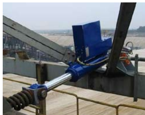
НКА в качестве привода отбойной плиты крупного карьерного комплекса
